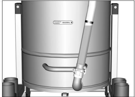
**Указание:** Червената маркировка на изпускателния маркуч показва максимално допустимото ниво на запълване.
