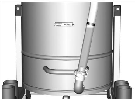
**Aviso:** A marcação vermelha na mangueira de escoamento indica o nível de enchimento máximo permitido.
