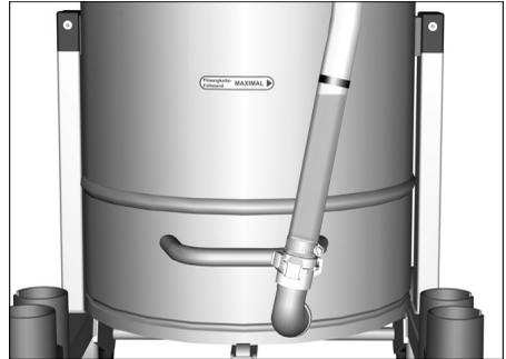
**Instructie:** De rode markering op de aftapslang geeft het maximale vulniveau weer.
