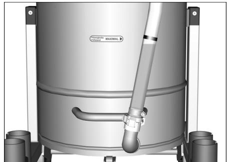
**Υπόδειξη:** Το κόκκινο σημάδι στον ελαστικό σωλήνα απορροής δείχνει τη μέγιστη επιτρεπόμενη στάθμη πλήρωσης.
