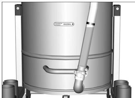
**Anmärkning:** Den röda markeringen på avtappningsslangen visar den maximalt tillåtna nivån.
